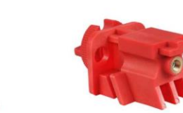
Minyatür Devre Kesici Emniyet Kilidi Ürün Kodu: BD-D20 2 adet asma kilit takılabilir. Küçük ebatlı devre kesiciler içindir Ölçüler: 7 - 15mm aralığında
